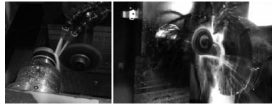
图 15 面齿轮修整及磨削加工试验
